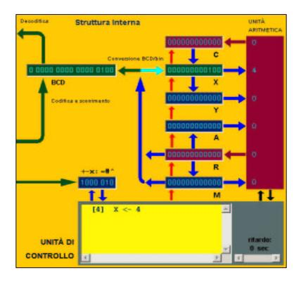
Dopo numerosi cicli di istruzione, in cui l'unità di controllo ha eseguito metodicamente le istruzioni e deciso qual è la successiva istruzione, il nostro "4" è stato visualizzato e l'unità di controllo può tornare alla sua routine di attesa. Tutto ciò ha richiesto una frazione impercettibile di secondo. Si
