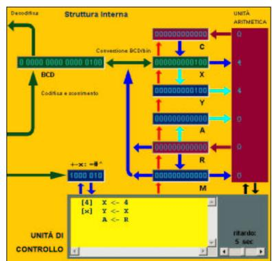
poi l'unità di controllo fa trasferire il contenuto dei due registri Y e A nelle reti logiche dell'Unità Aritmetica alla quale essi sono collegati perché venga effettuato il calcolo richiesto; infine il risultato (4) dell'operazione viene memorizzato nel registro R e da qui ricopiato nel registro X affinché la consueta sequenza di visualizzazione faccia apparire un "4" sul display della calcolatrice.
